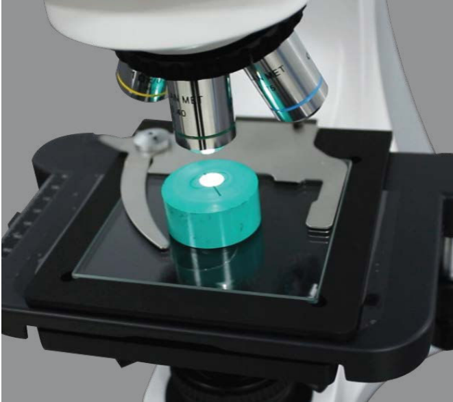
Çift katmanlı mekanik hareketli tabla 233x147 mm
