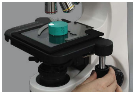
XY hareket kabiliyeti 78x54mm
