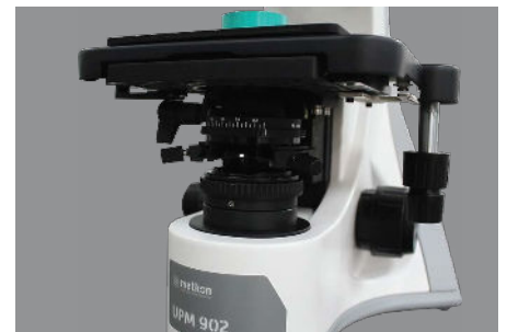
X-LED Full Koehler tipi geçirgen aydınlatma
