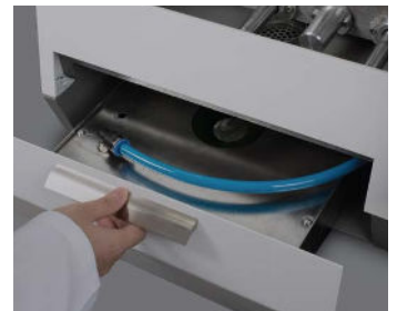
9 lt kapasiteli entegre devir daim soğutma tankı
