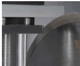
Kesme işlemi esnasında bileme yapabilen disk bileme ünitesi
