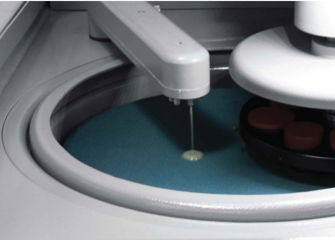
Çuha Yüzeyine Eşit Şekilde Süspansiyon Damlatabilen Otomatik Hareketli Dozajlama Kolu
